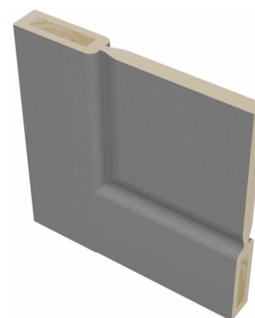
Разрез полотна серии СИЦИЛИЯ, филенка 20мм. Царга 110x38мм.
